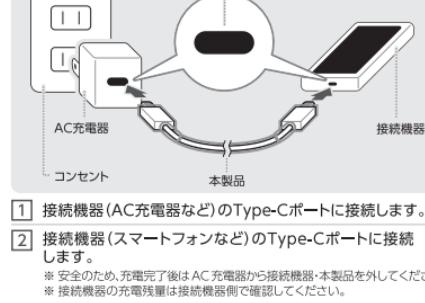
① 接続機器(AC充電器など)のType-Cポートに接続します。
