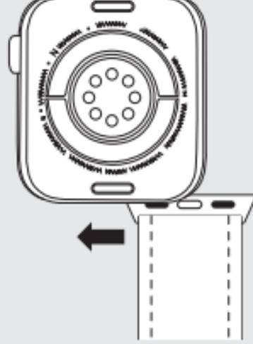
清潔な柔らかい平面(糸くずの出ない柔らかいマイクロファイバー製のクロス、またはパッド入りのマットなど)の上にApple Watchの文字盤を下にして置き、本体の溝にバンドのジョイント部を合わせ、右または左にスライドしながらバンドを取り付けます。
