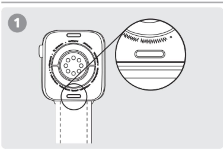
清潔な柔らかい平面(糸くずの出ない柔らかいマイクロファイバー製のクロス、またはパッド入りのマットなど)の上にApple Watchの文字盤を下にして置き、本体裏側のボタンを確認します。
