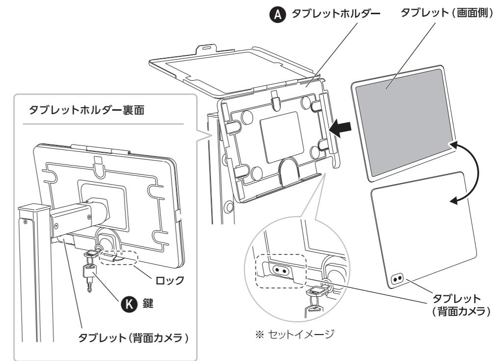
※タブレット(背面カメラ)はタブレットホルダーのカメラホールに合わせてセットしてください。
