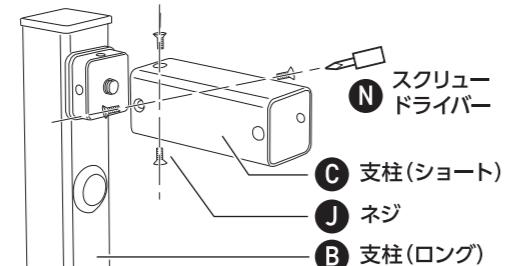
3 支柱(ショート)とタブレットホルダーをネジ2本で組み立てます。
