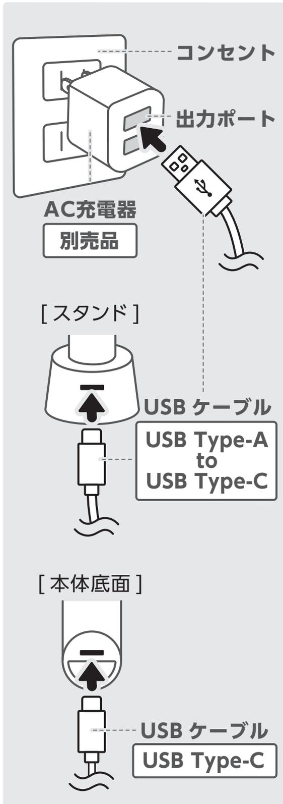
① AC充電器と、スタンドまたはモバイルバッテリー底面のUSB Type-C入力ポートをUSBケーブルで接続します。
