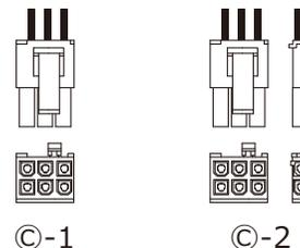
PCI-E 8 ピン (6+2) 電源コネクタは、6 ピンと 2 ピンに分かれていますので、拡張グラフィックカード上の 8 ピンコネクタには、合わせて接続します。(下図C-2)
