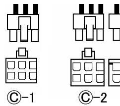
PCI-E 8ピン(6+2)電源コネクタは、6ピンと2ピンに分かれていますので、拡張グラフィックカード上の8ピンコネクタには、合わせて接続します。(右図Ⓒ-2)
