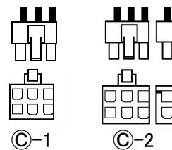
PCI-E 8ピン(6+2)電源コネクタは、6ピンと2ピンに分かれていますので、拡張グラフィックカード上の8ピンコネクタには、合わせて接続します。(右図Ⓒ-2)
