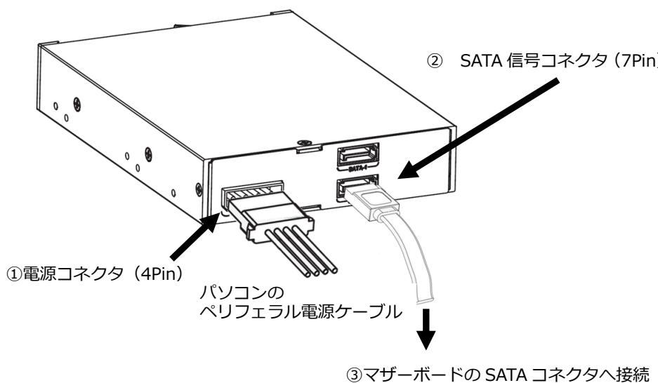
①パソコンのペリフェラル電源ケーブルを電源コネクタ（4Pin）に接続します。
