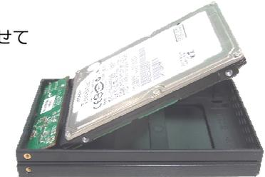
②HDD/SSDがケースに収まりましたら、付属のネジ4本で底部から固定してください。
