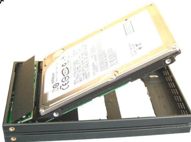
②HDD/SSDがケースに収まりましたら、付属のネジ4本で底部から固定してください。
