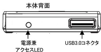
USB3.0コネクタ: 付属の USB 接続ケーブルを使用して、パソコンに接続します。
