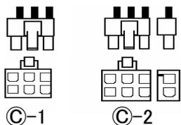
PCI-E 8ピン(6+2)電源コネクタは、6ピンと2ピンに分かれていますので、拡張グラフィックカード上の8ピンコネクタには、合わせて接続します。(右図③-2)
