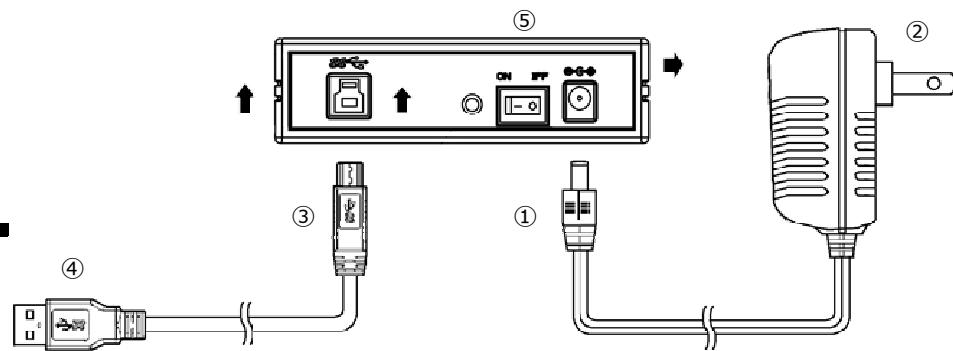
①付属のACアダプターのDCプラグを、本体のDC INに接続してください。
