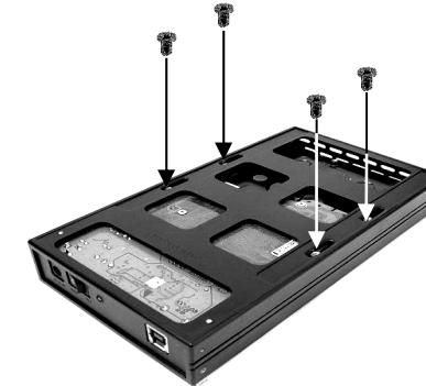
⚠ ネジ留め作業でケースを裏返す際に、HDDが落下しないようご注意ください。
