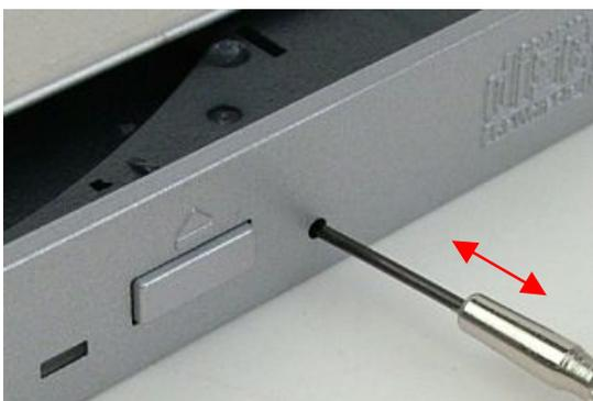
例ではドライバーを使って、軽く押し込んでから戻します。
