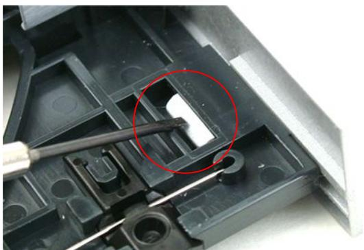
強く押しすぎると、ツメを破損する
